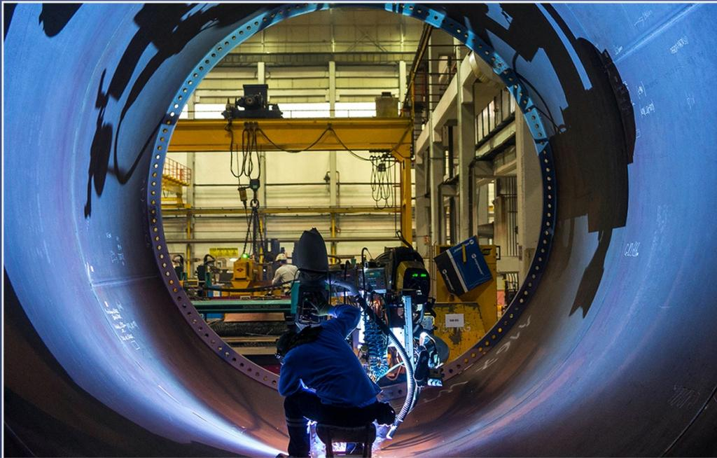
ロボット-自動-手動溶接
