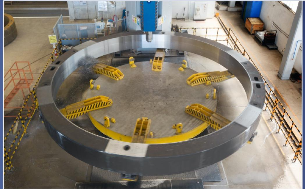
МЕХАНИЧЕСКАЯ ОБРАБОТКА СТАТОРА
